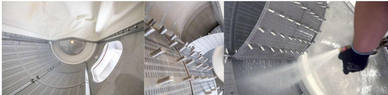
Grelha de drenagem “Fast Press” com limpeza otimizada: menos água e menos tempo
