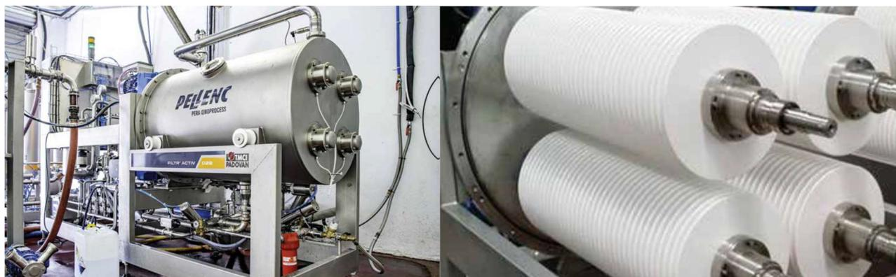
Filtração inovadora com discos de membrana cerâmica de rotação lenta, sem abrasão
